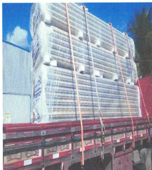
FOTO 03: TELHA METÁLICA SANDUICHE TRAPEZOIDAL 2 FACES TR40.
